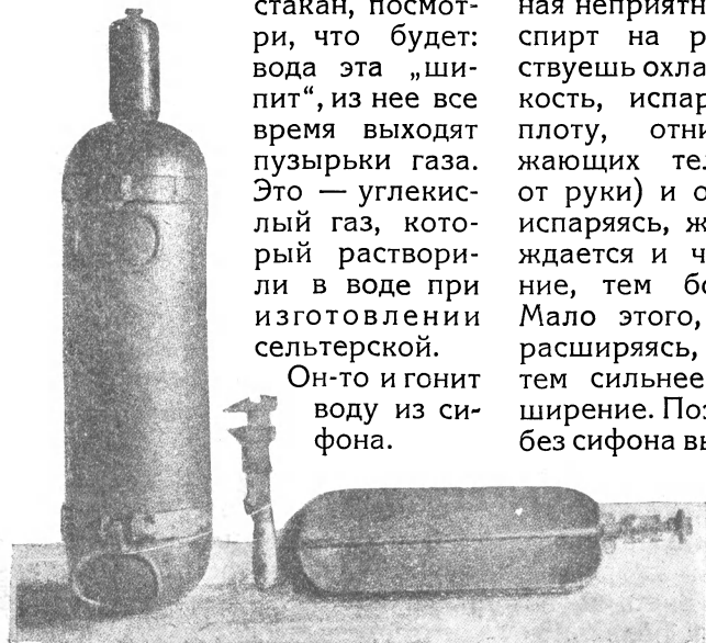
Газовый баллон. Справа—разрез баллона
